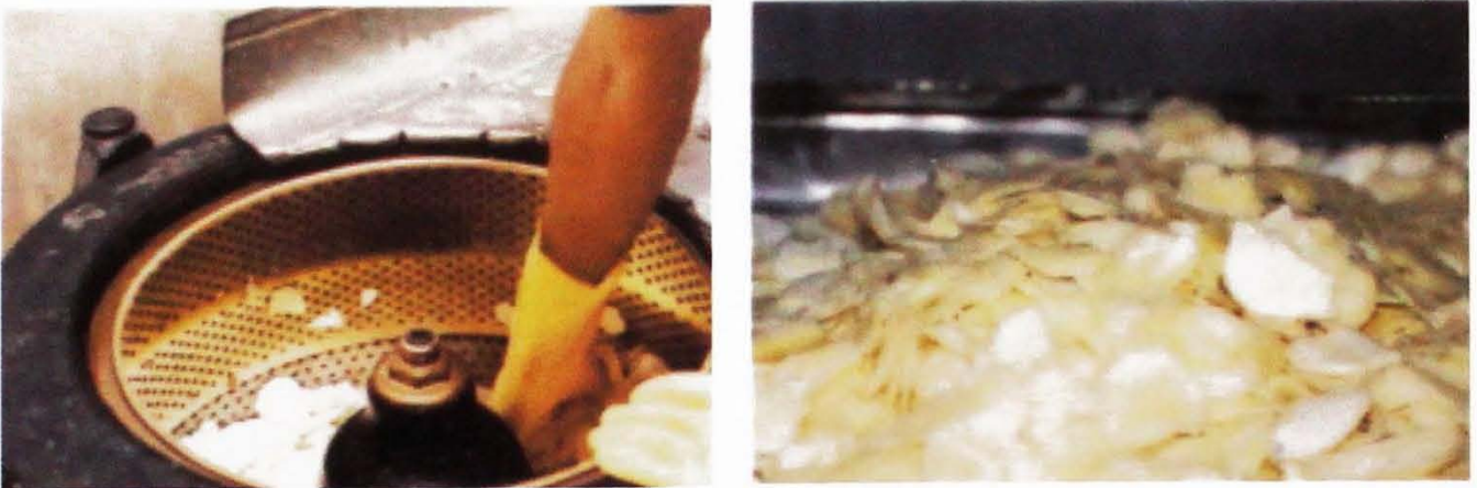
Fig. 22. Remoção do excesso de água das rodellas de mandioca por centrifugação.
