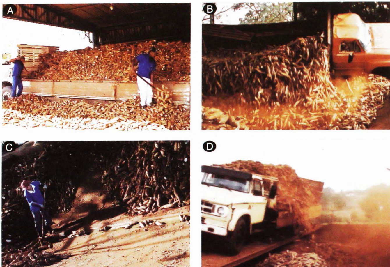
Fig. 2. (A) Descarregamento com o auxílio de pás. (B) Descarregamento por tombamento. (C) Alimentação da rosca sem fim. (D) Descarregamento por tombamento em plataforma inclinável.
