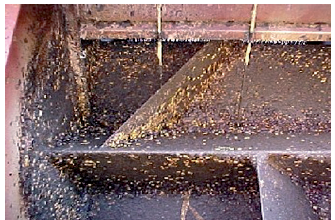
Figura 6. A mucilagem e os resíduos do café úmido causam obstrução dos furos do distribuidor de ar quente, o que dificulta ou impede a passagem do fluxo do ar de secagem.
