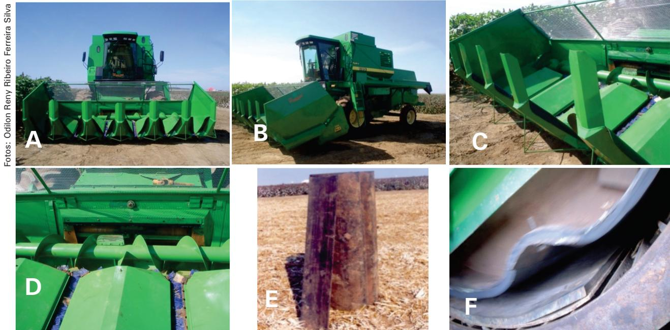
**Figura 37.** Colheitadeira com plataforma de milho adaptada para a colheita da mamona, com detalhes das adaptações realizadas na plataforma; A: Vista frontal; B: Vista lateral; C: Detalhe da plataforma colhedora das plantas; D: Correias com cerdas de náilon para o despojamento e condução dos cachos e sem fim alimentador; E: Detalhe do côncavo e do cilindro batedor recoberto com borracha; F: Côncavo e do cilindro batedor montados na máquina prontos para o descascamento.
