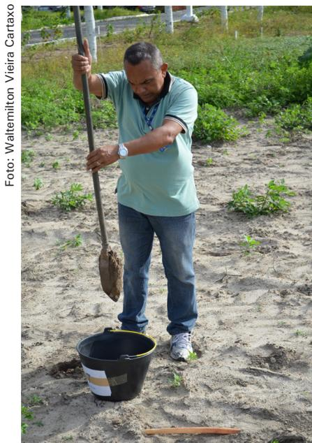
**Figura 9.** Retirada das amostras de solo com o trado.
