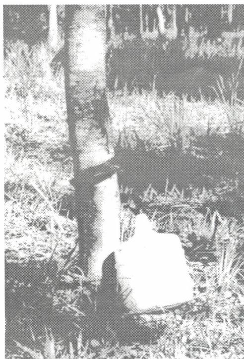
**MÉTODO DE COLETA DE ÁGUA DE ESCORRIMENTO DE TRONCO**
