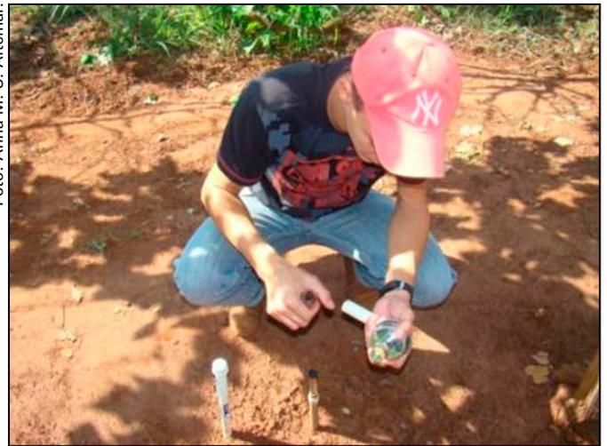
Fig. 3. Leitura de tensiômetros em área sem cobertura vegetal do solo.
