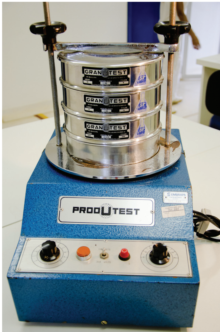
Figura 3. Agitador mecânico para análise granulométrica.
