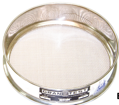
Figura 2. Peneira de 2 mm (A) e de 1 mm (B) para análise granulométrica.
