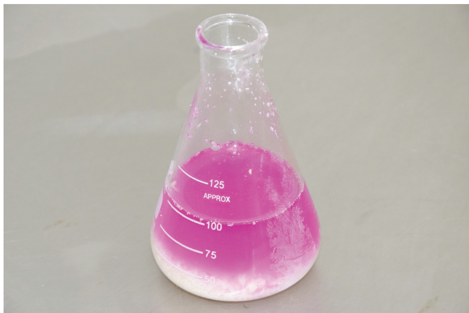
Figura 7. Erlenmeyer com amostra de farinha após obter coloração rosada na determinação da acidez.
