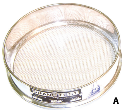
Figura 2. Peneira de 2 mm (A) e de 1 mm (B) para análise granulométrica.
