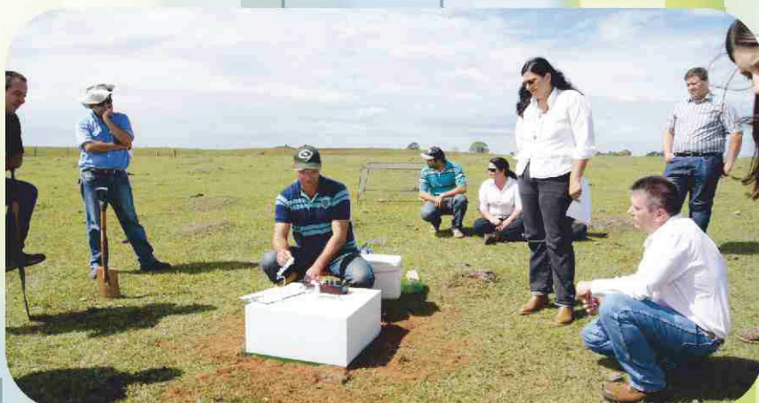
Caixas coletoras fechadas possibilitam avaliar o quanto é emitido de gases pelo solo e pelas plantas
