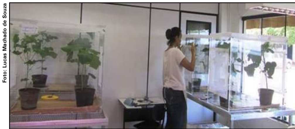
Figura 1. Gaiolas de acrílico (90x80x45cm) utilizadas nos testes de dupla escolha.
