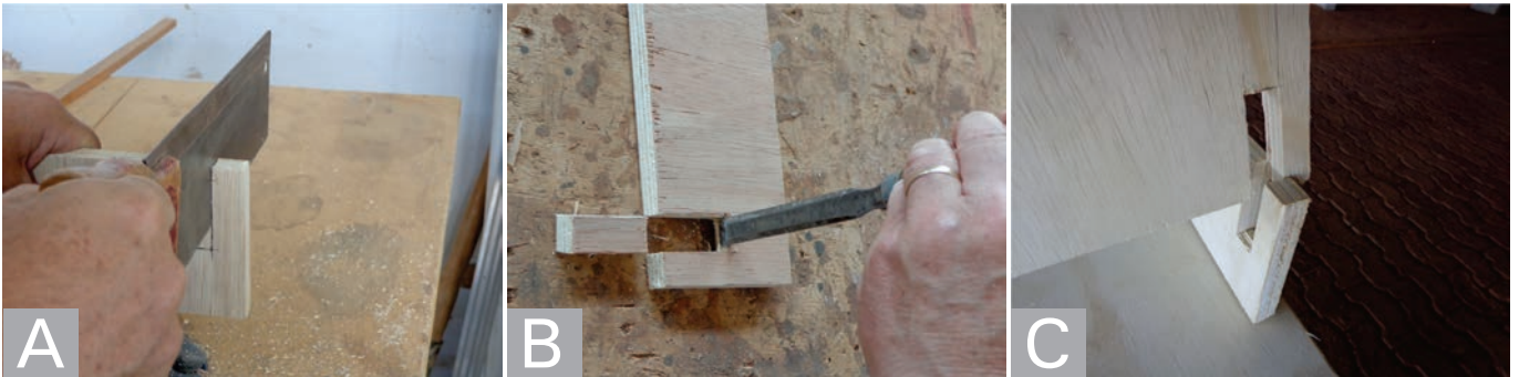
Figura 7: Corte dos encaixes e fixação das laterais da mesa.
