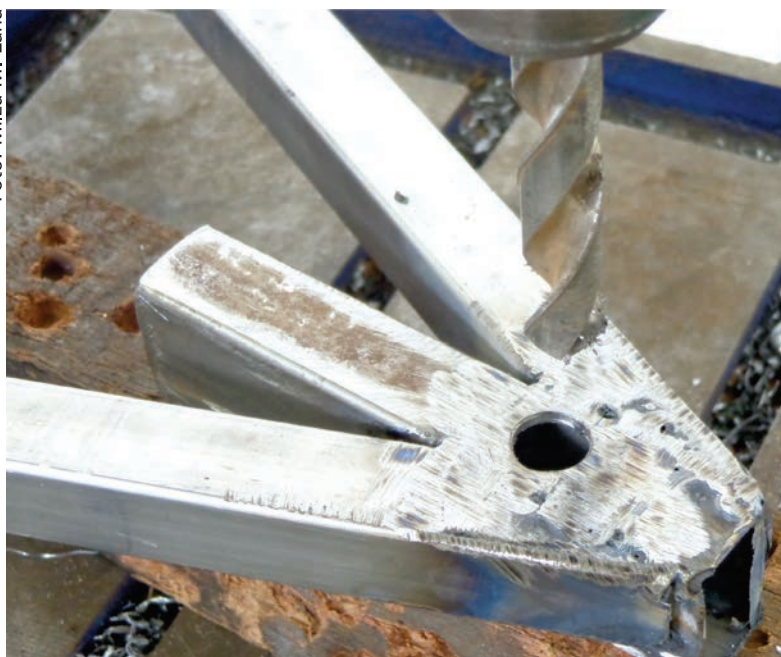
Figura 15: Orifício para encaixe do parafuso para regulagem de altura do cavalete.
