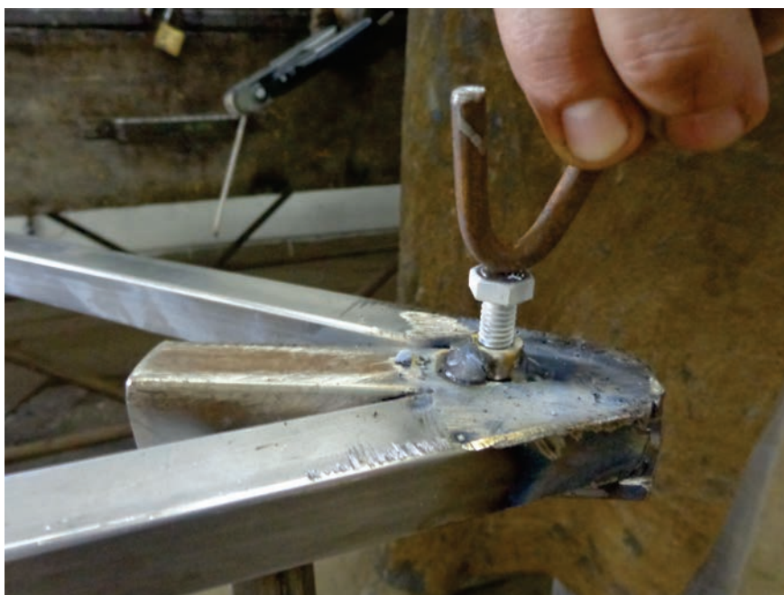
Figura 16: Solda do parafuso e borboleta que servirão para regular a altura do cavelete.
