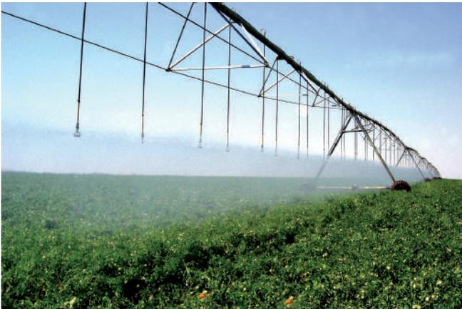
**Figura 4.** Sistema de irrigação por aspersão tipo pivô central em lavoura de tomate para processamento industrial.
