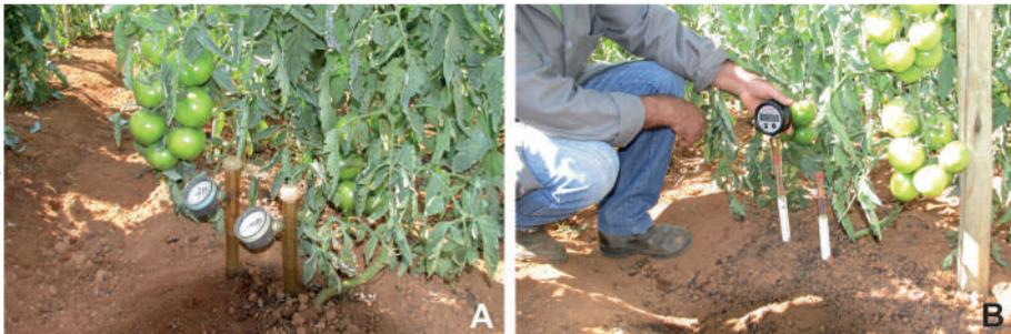
**Figura 25.** Tensiômetros com vacuômetro metálico tipo Bourdon (A) e leitura com tensiômetro digital (B) instalados a 50% e 100% da profundidade efetiva do sistema radicular do tomateiro.
