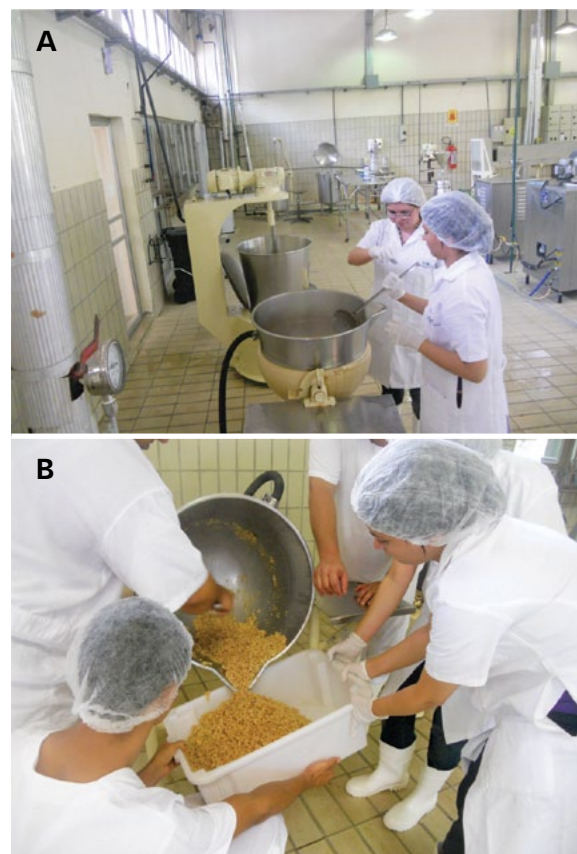
Figura 5. Tacho a vapor para hidratação e aquecimento da PTS (A) e PTS hidratada (B).
