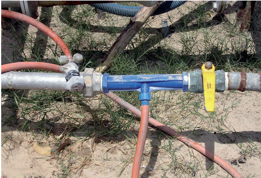
Figura 5. Injetor tipo Venturi utilizado na fertirrigação.
