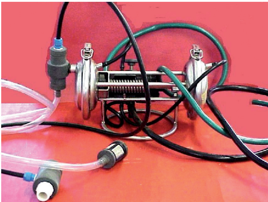
Figura 4. Bomba injetora com acionamento hidráulico utilizada na fertirrigação.
