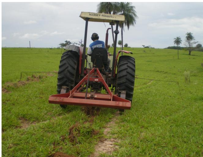
**Figura 11.** Marcação das linhas de plantio usando barra de ferro acoplada ao trator.
