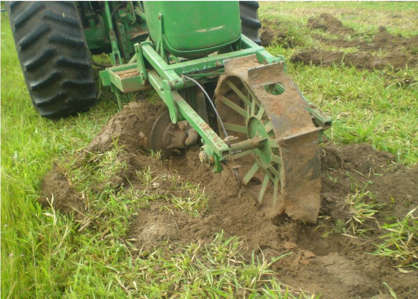
**Figura 12.** Subsolador florestal (“Ripper”) preparando a linha de plantio.
