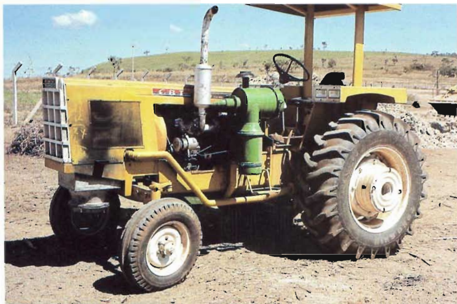
Fig. 2 — Trator CBT-2080 equipado com gasogênio EXPLO, em sistema dual — óleo diesel e gasogênio a carvão vegetal.
