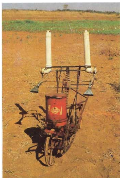
Fig. 18 — Plantadeira à tração animal, com dispositivo para a aplicação do inseticida granulado diretamente no cartucho do milho.
