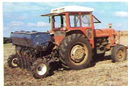
Fig. 22 — Vista do protótipo de semeadeira com sistema de facas e rotor de limpeza.
