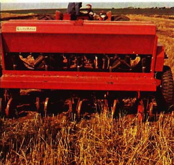
Fig. 23 — O plantio direto com equipamento de tripla disco reduz o gasto com combustíveis, com fertilizantes e, o que é mais importante, diminui os efeitos da erosão.
