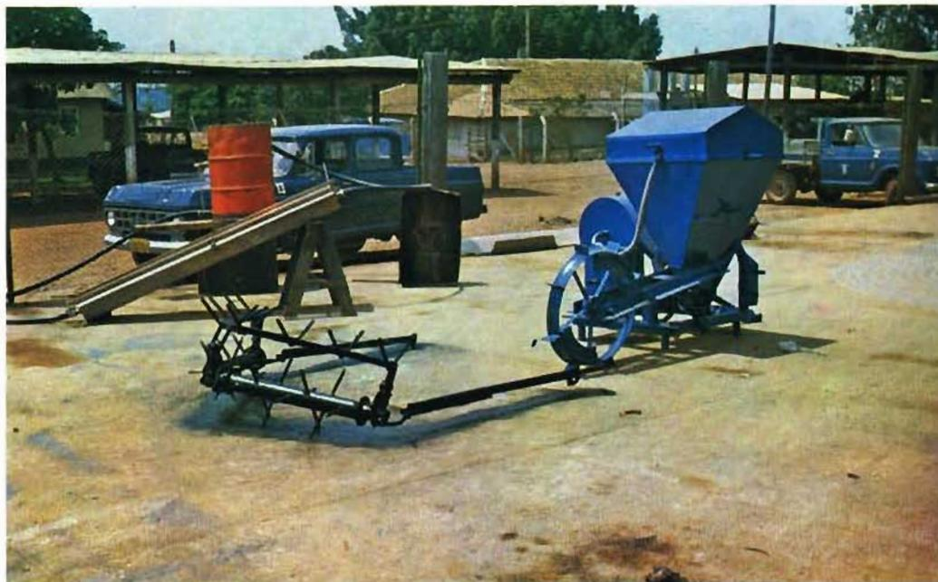
Fig. 82 — A necessidade de equipamentos específicos para a implantação de pastagens com *Andropogon*, levou a pesquisa a desenvolver um protótipo que obtém bons resultados.
