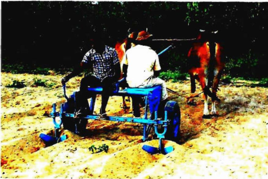
Fig. 60 — O "multicultor" permite arar, sulcar, gradear, plantar, capinar, subsolar e pode ser construído localmente.
