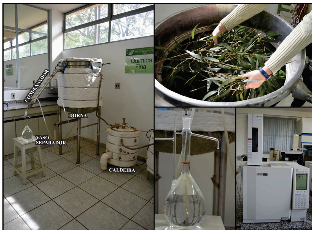
Figura 1: Sistema de extração por destilação por arraste a vapor d'água em escala semi-piloto e cromatógrafo a gás com detector de ionização de chama. (Equipamento de extração: Fazenda Alpina, Águas de Santa Barbara, SP).
