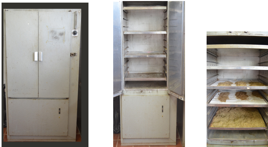
Figura 6: Secadores elétricos com circulação forçada de ar e controle de temperatura.
