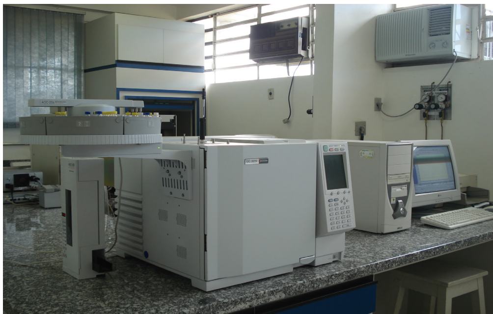
Figura 3: Cromatógrafo a gás com detector de ionização de chama (CG/DIC).
