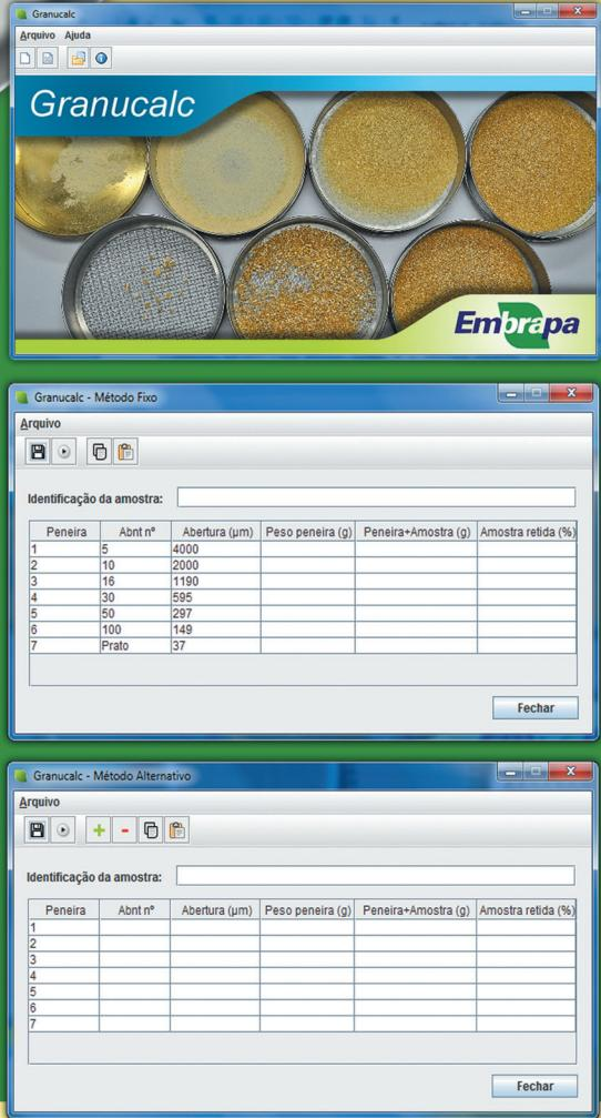
O Granucalc é aplicado para calcular e interpretar o resultado da análise de granulometria, ou seja, o Diâmetro Geométrico Médio (DGM) e o Desvio Padrão Geométrico (DPG) das partículas do milho. O programa calcula a granulometria pelos métodos fixo, com peneiras de abertura pré-definida, ou alternativo, onde podem ser selecionadas peneiras em conformidade com as utilizadas no laboratório para a análise de granulometria.
