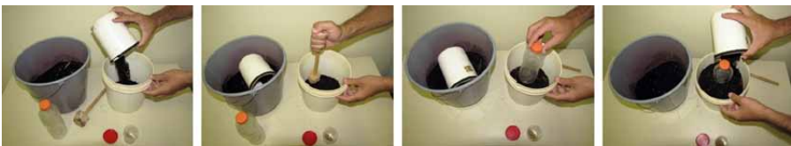
Fig. 1. Etapas do preenchimento do molde.
