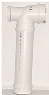
Figura 5. Peneira manual feita com cano PVC para extração de conídios produzidos em arroz em pequena escala.
