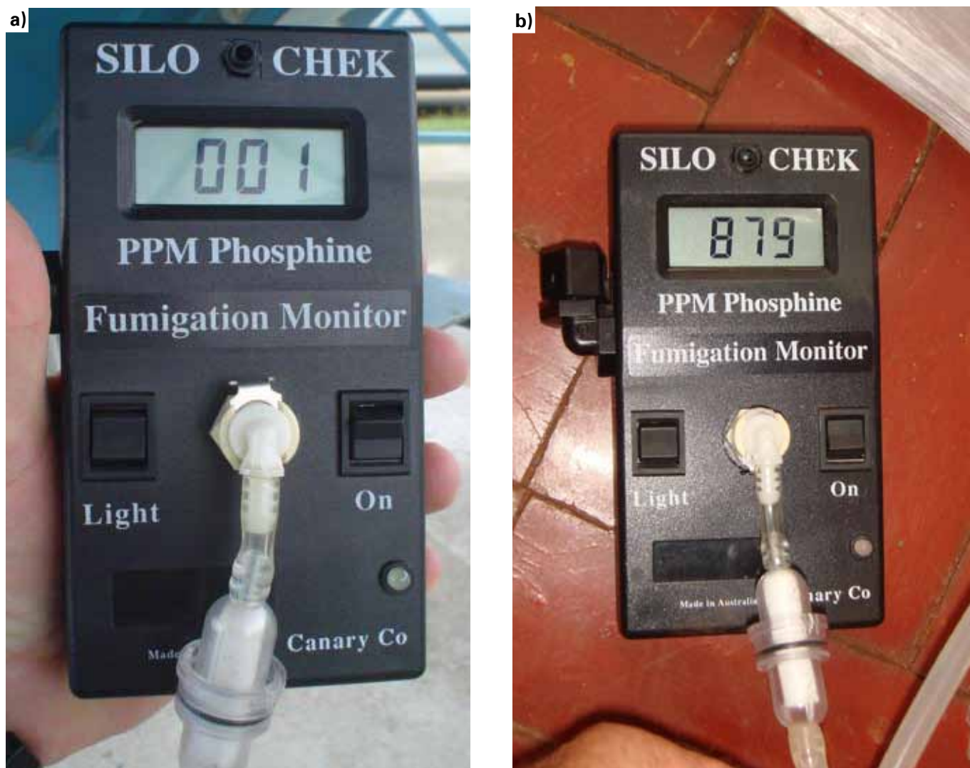
Figura 10. Medidor de fosfina Silochek usado para verificar a concentração do gás durante o expurgo das sementes; a) medidor de concentração de fosfina; b) medidor fazendo leitura do gás. Londrina, 2013
