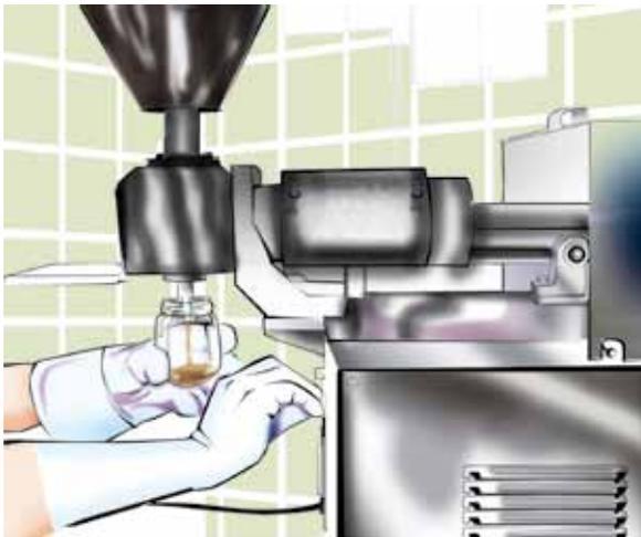
**Figura 7.** Enchimento a quente, utilizando-se enchadeira semiautomática.
