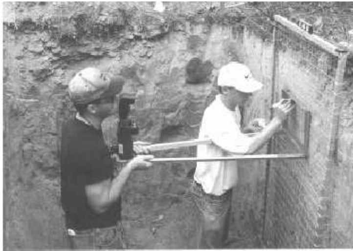
Figura 16. Aparato para obtenção de imagens com câmera digital das raízes do solo. Observa-se a malha para referência e o suporte montado da câmera (de YARBROUGH, 2000).
