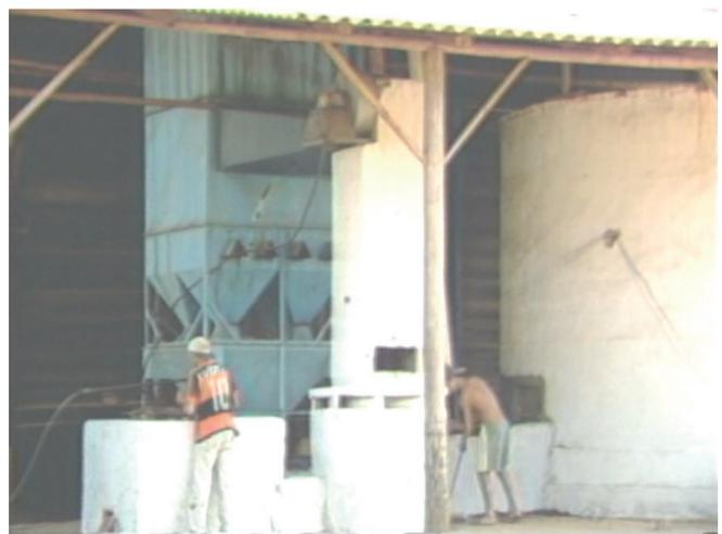
Figura 9. Sistema combinado modelo UFV, secador e silo secador.
