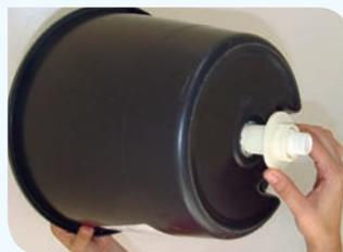
a) Perfurar o fundo do balde de 8 litros e inserir o adaptador de caixa d'água na abertura.
