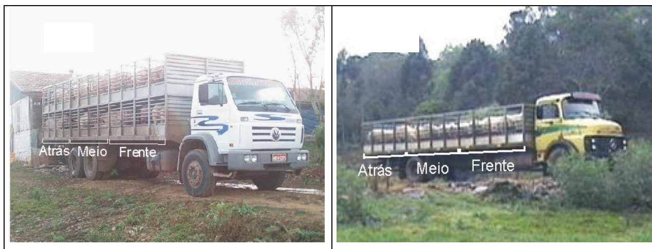
Figura 1. Modelos de carroceria TRIEL-HT dupla (a) e TRIEL-HT simples (b), definindo a posição do animal na frente, meio e atrás da carroceria.
