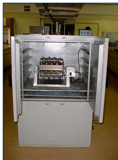
Figura 2 - Estufa com temperatura controlada, contendo o agitador do tipo Wagner com amostras.
