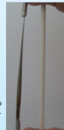
**Figura 3.** Desgaste do eixo de aço e o eixo de porcelana.
