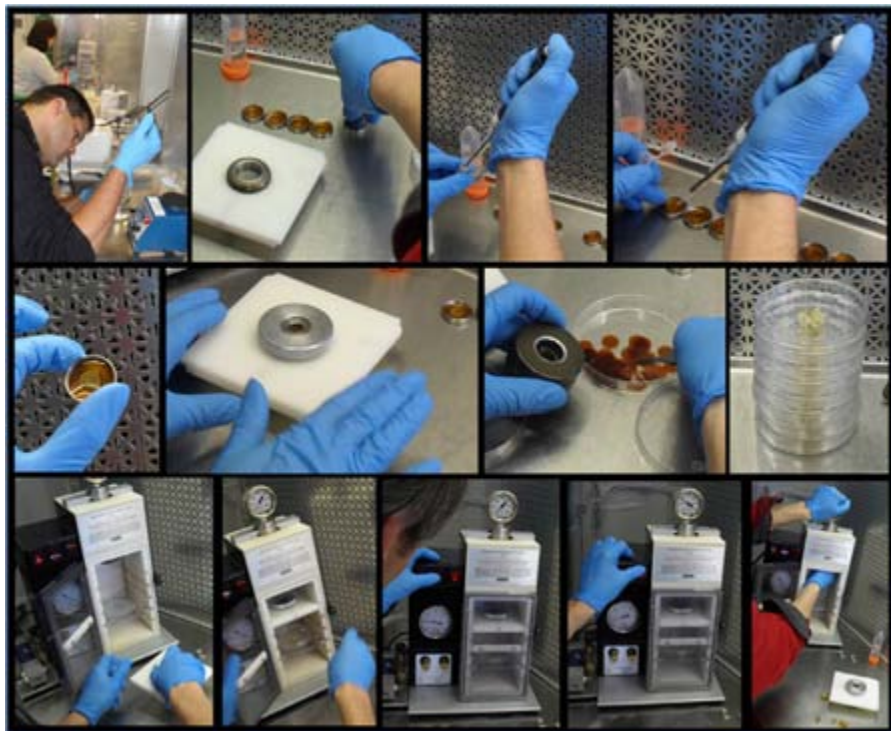
Figura 17. Algumas etapas do processo de montagem da câmara de bombardeamento.
