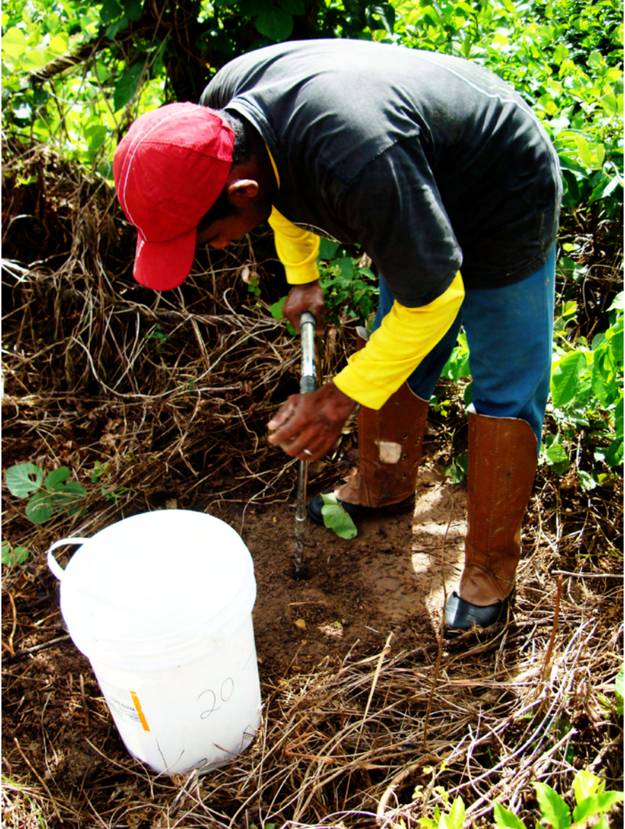
Figura 1. Amostragem do solo com trado holandês em cultivo de palma de óleo.
