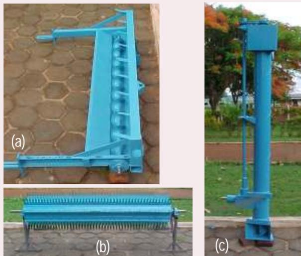
Figura 1. Componentes da colhedora Stripper: a) Chassi da colhedora com transportador horizontal de grãos; b) Cilindro colhedor; c) Elevador de grãos da colhedora.
