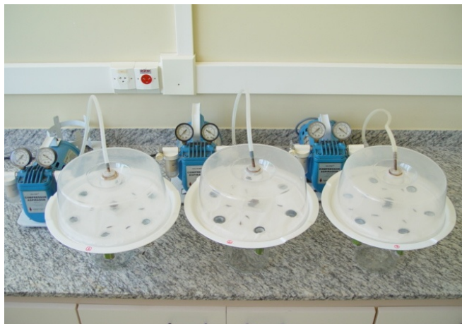
Figura 3. Olfatômetros usados na avaliação da não preferência de Orius insidiosus e Doru luteipes para larvas de Spodoptera frugiperda (Lepidoptera: Noctuidae), alimentadas em milho Bt e não Bt.
