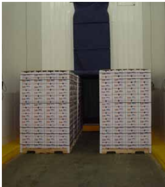
Figura 6. Sistema de resfriamento rápido utilizando-se ar frio forçado em pequenas frutas.
