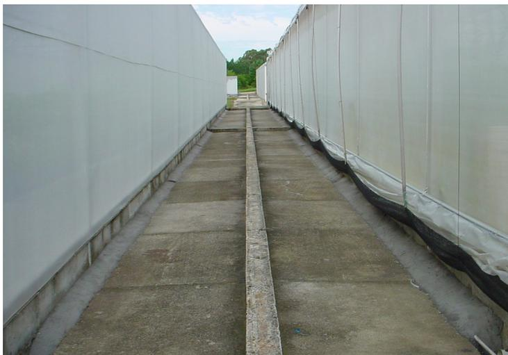
**Figura 14.** Vista lateral de viveiro-telado demonstrando o uso de cortinas plásticas do polímero polietileno, usadas para minimizar a queda de temperatura do interior da estufa durante a noite.
