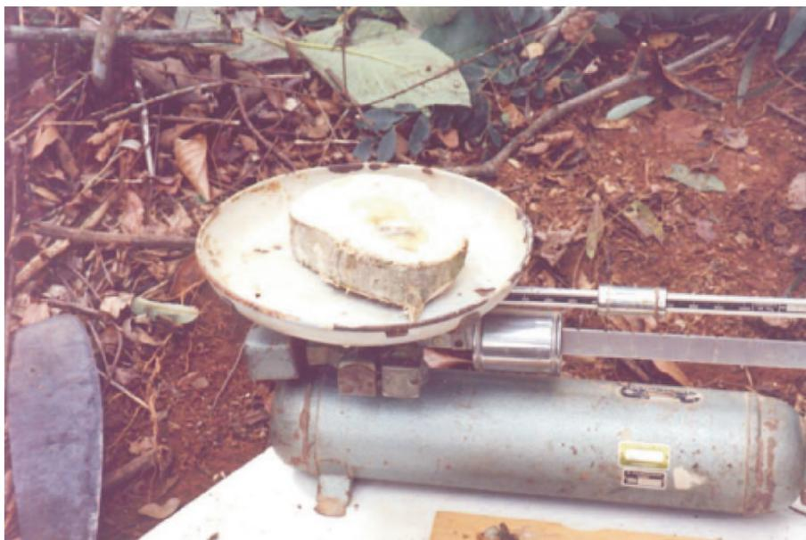
Figura 2 – Detalhe da pesagem de uma amostra do caule da seringueira (disco).
