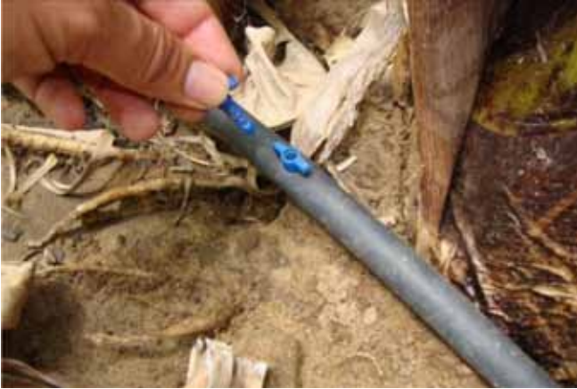
Figura 8. Gotejador comercial de baixo custo em sistema de irrigação localizada.
