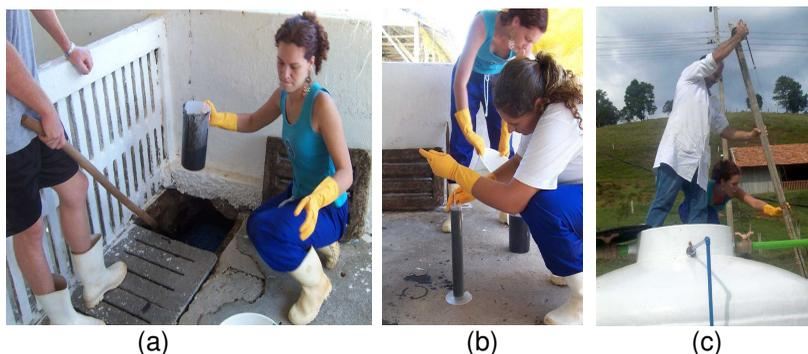
**Fig. 3.** Coleta de dejetos brutos em um de três pontos de coleta da granja (a), medida de densidade do dejetos (b) e coleta no primeiro depósito do Sistema Compacto de Tratamento após a peneira (c).
