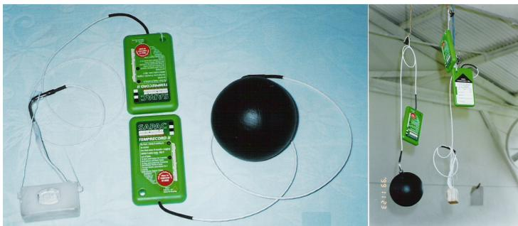
**Fig. 4.** Registradores de temperaturas de bulbo seco e úmido, globo negro
