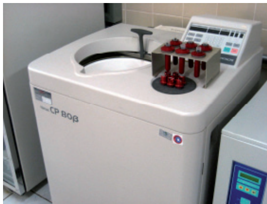
Figura 2. Centrífuga modelo Himac CP 80β (Hitachi Koki®, Japão) utilizada no gradiente de sacarose.
