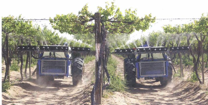
Figura 4. Aspecto de pulverizador eletrostático para a cultura da uva
