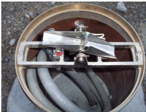
Fig. 8. Sistema de medida da altura pluviométrica em pluviômetro de báscula.
