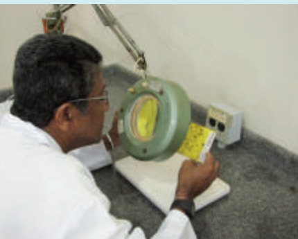
Figura 4. Aspecto do procedimento de leitura da armadilha em laboratório, utilizando lupa de bancada com articulação. (1,8 X).
