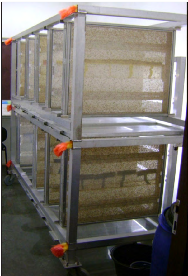
Figura 2. Aspecto geral das gaiolas de oviposição, utilizadas nos experimentos em escala industrial. Biofábrica Moscamed Brasil, Juazeiro-BA. 2009.
