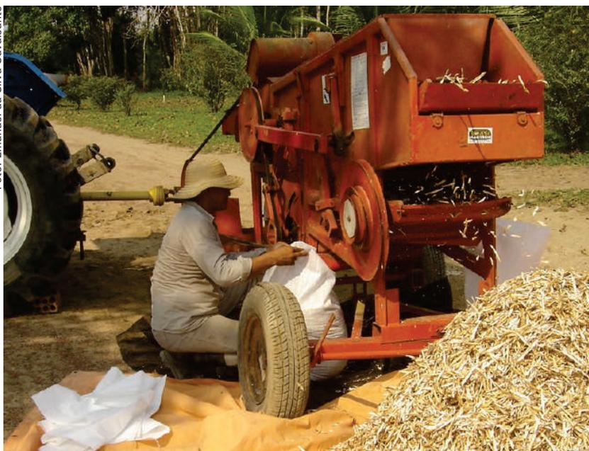
Figura 23. Trilha mecânica.
