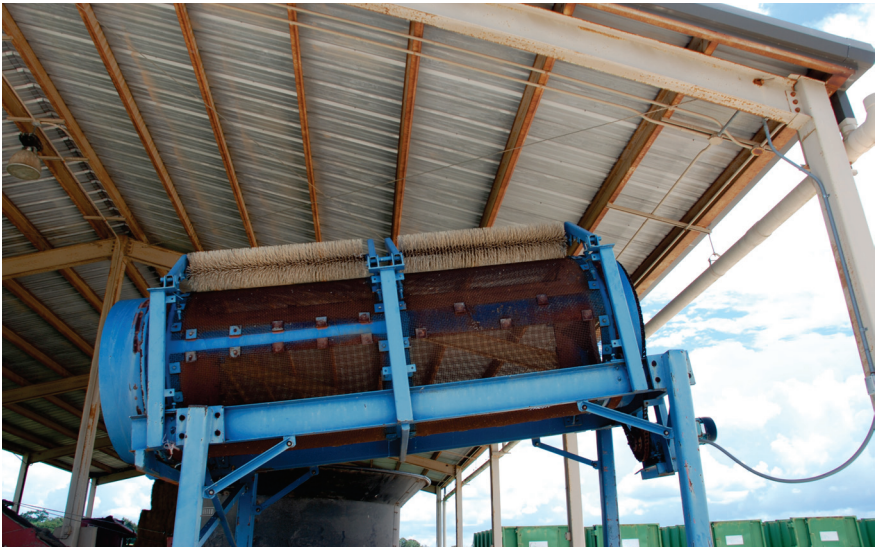
Figura 3. Peneira rotativa para peneiramento do composto
