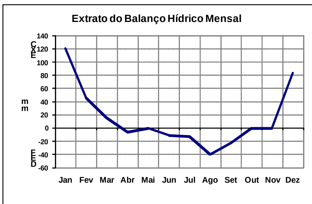
Figura 2. Representação do balanço hídrico, estratificando os períodos de retirada e reposição de água, para o município de Rio Verde de Mato Grosso (MS).
