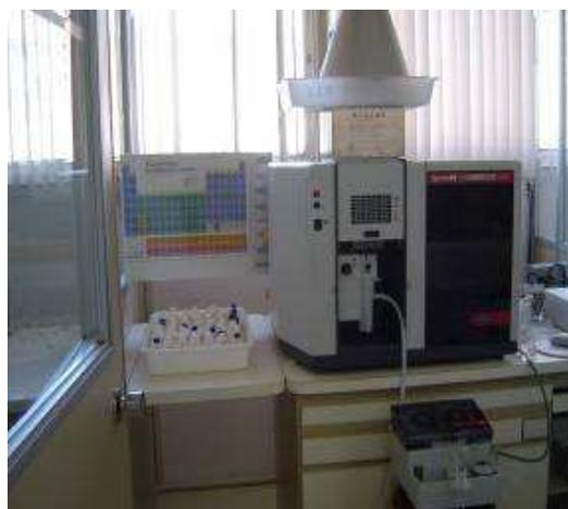
**Figura 12** - Espectrofotômetro de absorção atômica do LEM.
