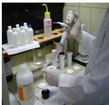
**Figura 8** - Amostras recebendo o ácido fluorídrico ( $\text{HF}$ ) 40%.
