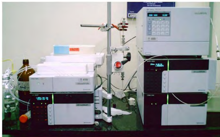
Figura 6. Foto do cromatógrafo líquido de alta performance, situado no Laboratório de Proteínas Tóxicas, da professora Célia Carlini/UFRGS, equipado com coluna Shin-pack CLC-ODS (M), Shimadzu, (150mm x 4,6mm, tamanho da partícula de 5 \mu m e diâmetro de poro 100 Å) e coluna guarda Shin-pack, Shimadzu, CLCG-ODS. Programado para um gradiente de eluição de 5% a 90% Metanol, pH 3,9.
