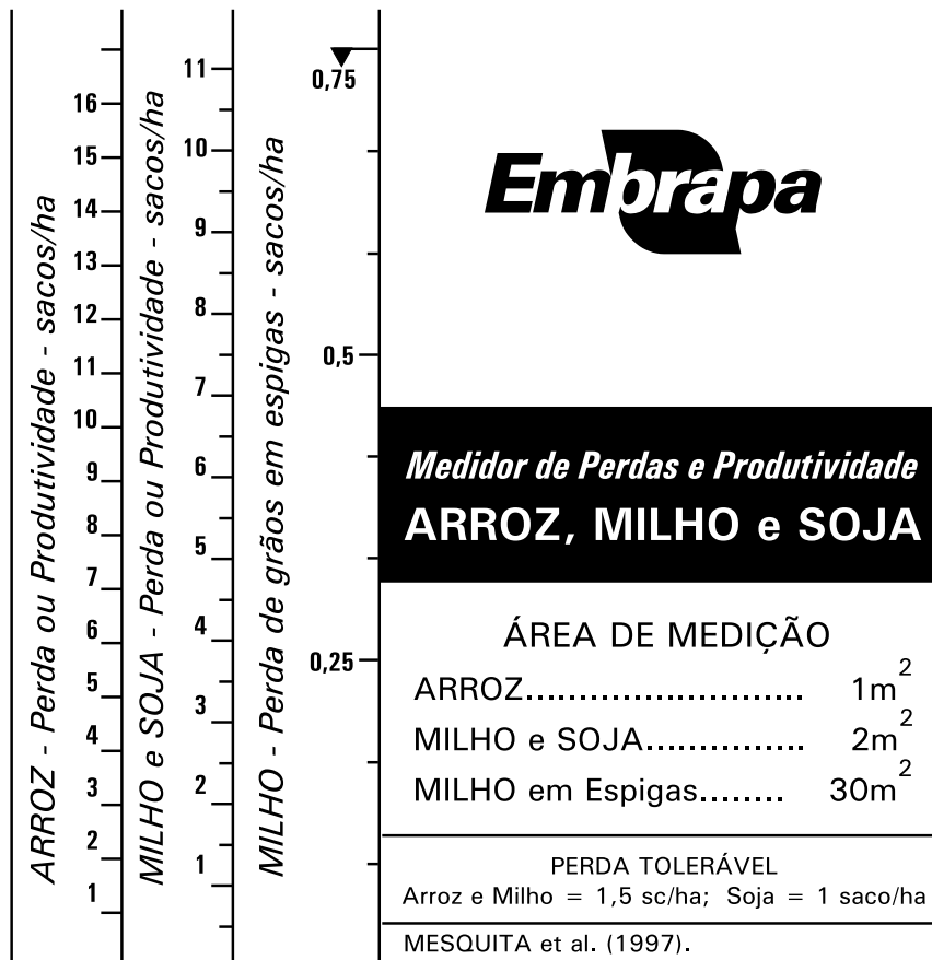
Figura 6.3. Tabela impressa no medidor com os valores de perdas e de produtividade. Embrapa Soja. Londrina, PR.
