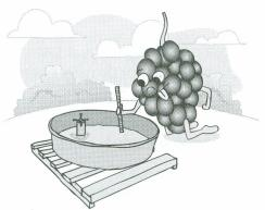
É um tanque cilíndrico de chapa galvanizada, com fundo plano, medindo 0,25 m de altura e 1,21 m de diâmetro. Esse tanque é colocado sobre um estrado de madeira e enchido com água.
